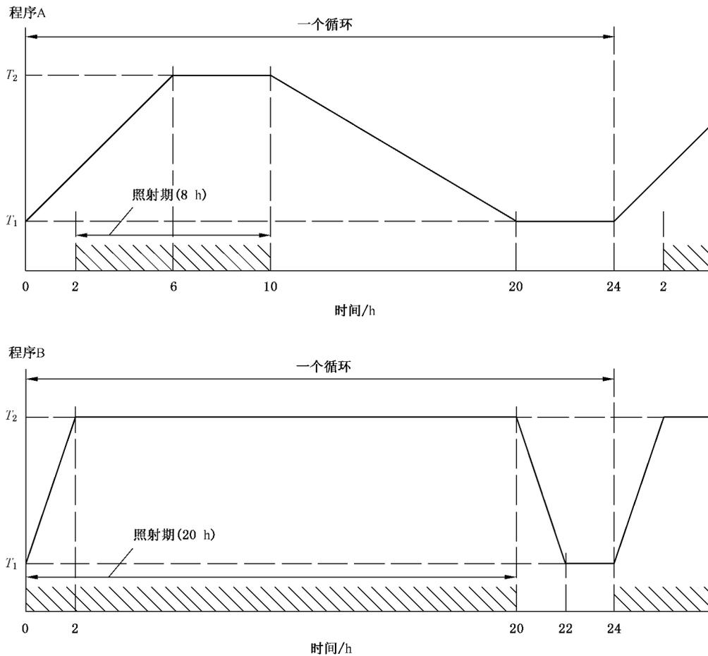
图 2 试验程序 A、B 和 C
