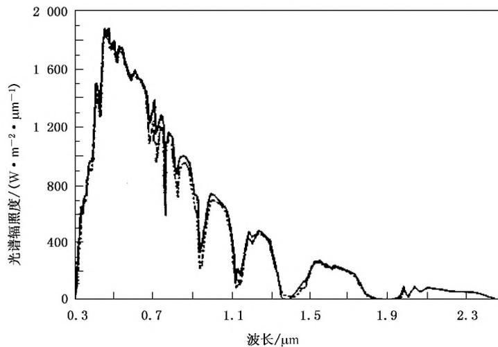
注：图中实线、虚线分别表示气溶胶消光的光学深度为 0.1 和 0.27。
